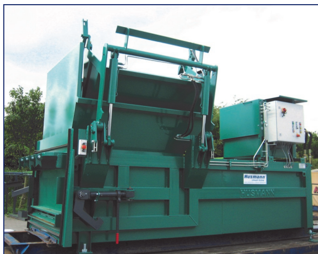
• MP 1300 mit angebauter Hub- Kippvorrichtung
