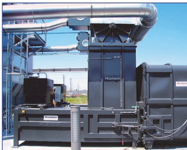
• MP 1300 mit Trichter unter Zellradschleuse
