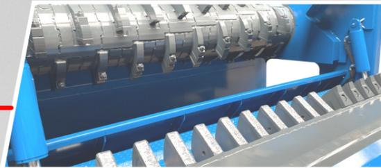
Brecherwerk (Schraubbare Werkzeuge)
