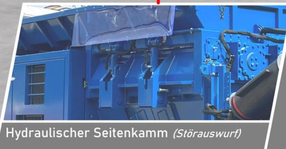
Der HL II ist mit einem aktiven hydraulischem Seitenkamm ausgestattet. Bei Überlast in Rückwärtslauf öffnen die Störauswurfklappen und lassen den Störstoff durch das Brecherwerk fallen. Das macht die Maschine unempfindlicher gegen Störstoffe. Stillstandzeiten durch Fremdstoffe werden dadurch reduziert.
